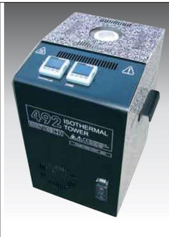
**ISOTOWER ITS-90 para calibración por puntos fijos
