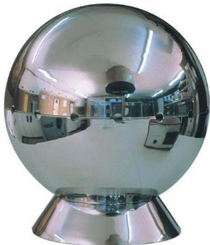
**Horno para calibración de termopares y fuente de cuerpo negro marca ISOTECH modelo SATURN 877**
