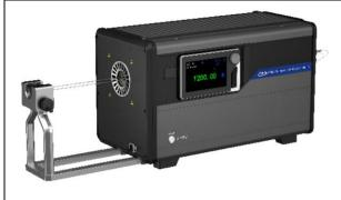
Calibradorde referencia de bloque seco ADDITEL modelo ADT878. Combinan un desempeño excelente en estabilidad, uniformidad axial, radial y carga térmica.
