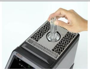
**Modelo PC**: Lectura multi canal termómetro de referencia, RTD´s, TC´s, respuesta eléctrica de transmisores. Documentación de pruebas, comunicación Hart y programación de pruebas de calibración
