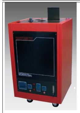
Horno dual y tubo de calor marca ISOTECH modelo para proveer un ambiente esencialmente libre de gradientes para fundir y congelar los puntos fijos de la ITS-90
