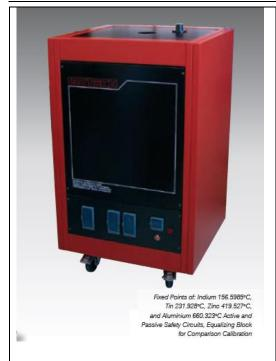
Horno de calibración de temperatura media de tres zonas marca ISOTECH modelo ITL-M-17703 Diseñado especialmente para realizar y mantener el punto fijo de solidificación de indio, estaño, zinc y aluminio.
